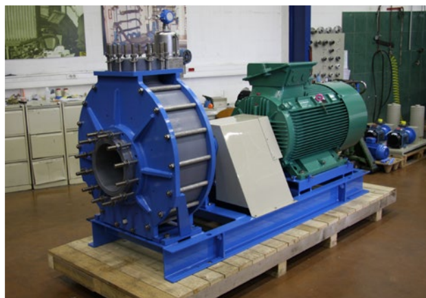
Pompe NP 300-250-400 - Roue hélico-centrifuge en SOMEDUR® DIAM 350mm
