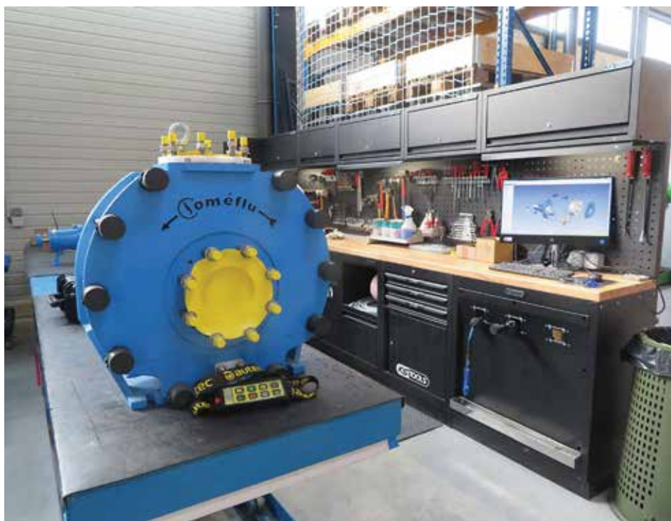
Les nouveaux postes de montage des pompes sont clairs et équipés d'un guide de montage en 3 dimensions sur écran !
